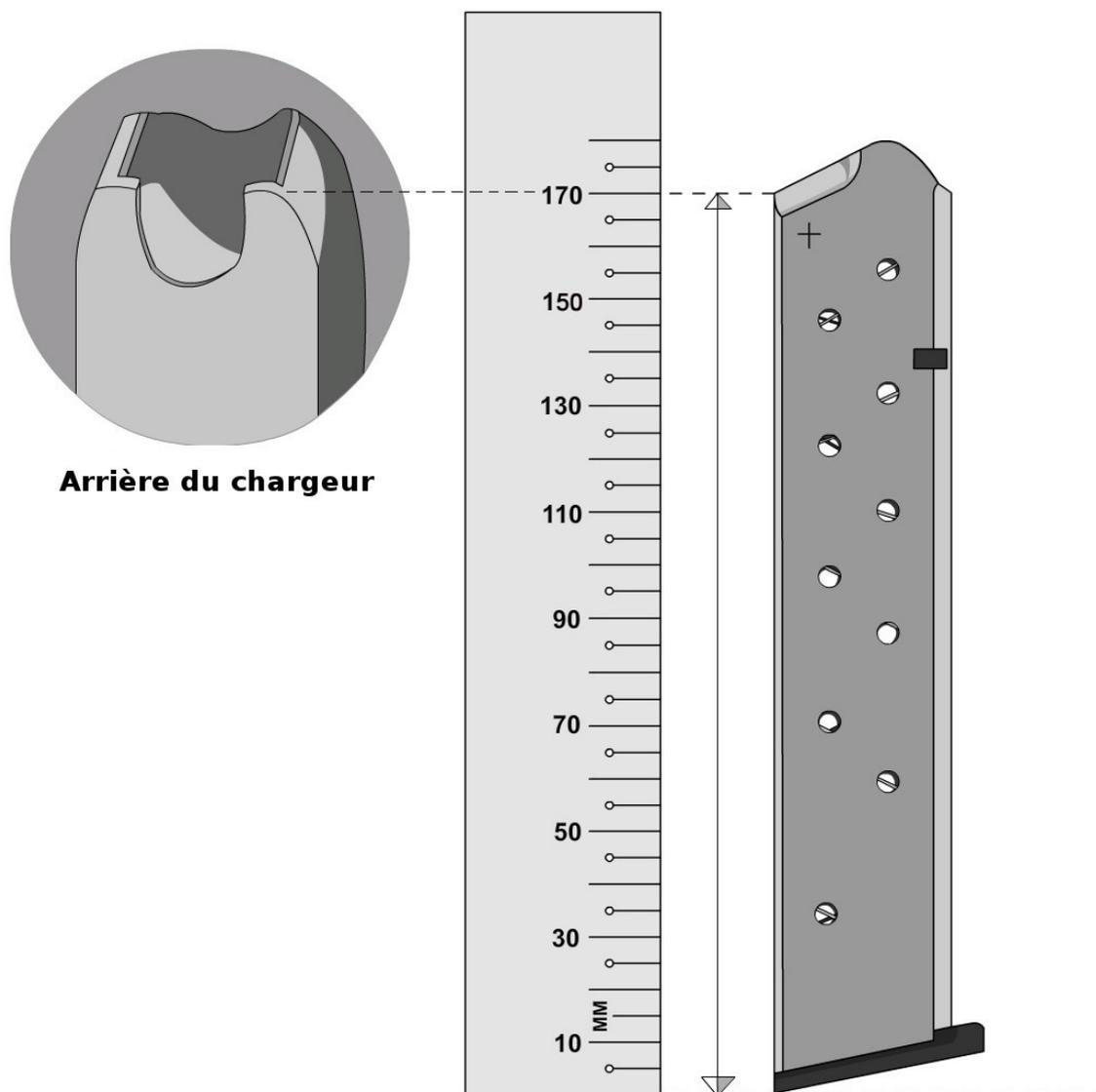
Le chargeur est érigé verticalement sur une surface plane, la mesure étant prise depuis la surface plane jusqu'à l'arrière de la lèvre de guidage, comme illustré. Seuls les chargeurs solides, rigides, sont permis (par exemple les chargeurs flexibles, tambours, « J », « L », « T » ou similaires sont interdits).
